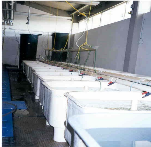
Figura 11. Sistema de cultivo en la Unidad de Maricultura de la UABCS (Pichilingue, La Paz, B.C.S.). Al fondo de la fotografía se observan 2 tanques cónicos de sedimentación.
