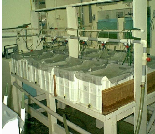
Figura 10. Sistema de cultivo de flujo abierto en el Bioterio del CIBNOR. Cuenta con 18 acuarios de 40 L, suministro de agua de mar filtrada a 5 micras y esterilizada con luz U.V.
