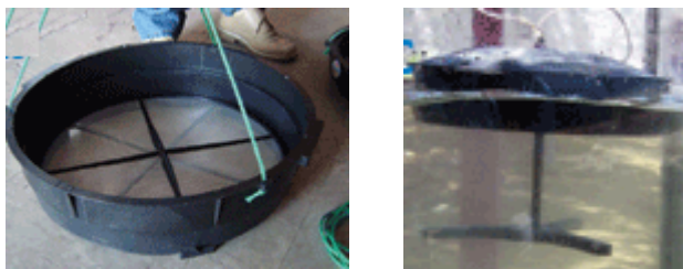
Figura 6. A la izquierda, la charola con borde retráctil y a la derecha, una charola con la abertura automática de la tapa en el momento del contacto con el suelo.
