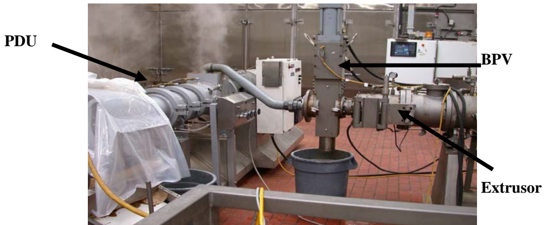
Figura 5. Extrusor con Unidad Densificadora de Productos o PDU.
