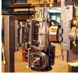
Figura 4b. Extrusor con Cámara de Control de Presión (EDMS)
