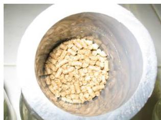
A raíz de esta experiencia, se cambió a un método inspirado de los usados en el CSIRO o en el OI, en el cual la muestra se pesa en un tamiz con malla mucho más fina (#40), que se fija en la boca de un frasco de 250mL conteniendo 200 mL de agua marina, de tal manera que el pelet sea bañado en el agua emergiendo a través de la malla.
